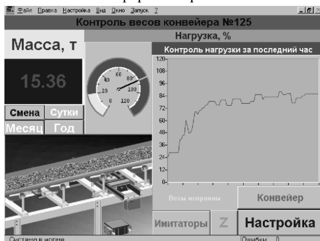
Рис.8.7. Пример интерфейса оператора конвейерной линии в Genie.
