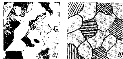
Рис. 14.6. Доэвтектоидная сталь с 0,3% С — феррит+перлит: а — микроструктура (X500); б — схема микроструктуры
