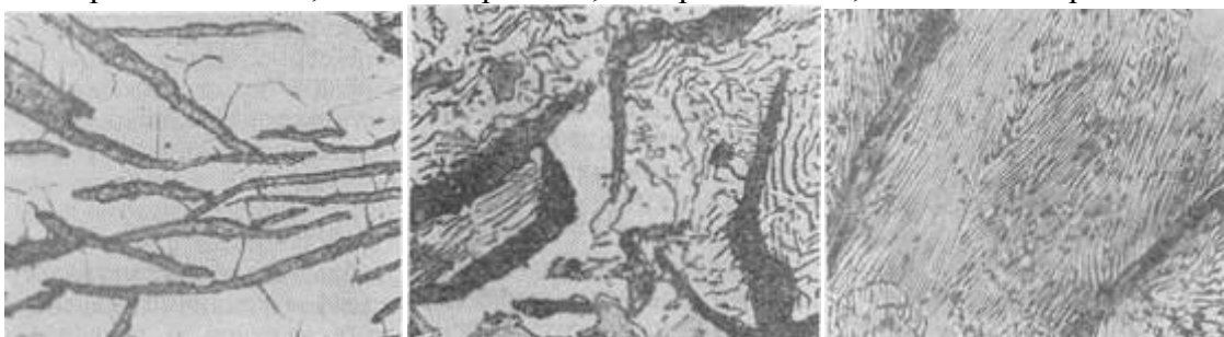
Рис. 6. Ферритный серый чугун — феррит и пластинчатый графит Рис. 7 Феррито-перлитный серый чугун — феррит + перлит и пластинчатый графит Рис. 8 Перлитный серый чугун — перлит + пластинчатый графит
