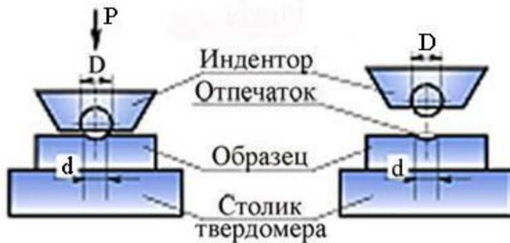
Рисунок 2 - Схема испытаний на твердость по Бринеллю
