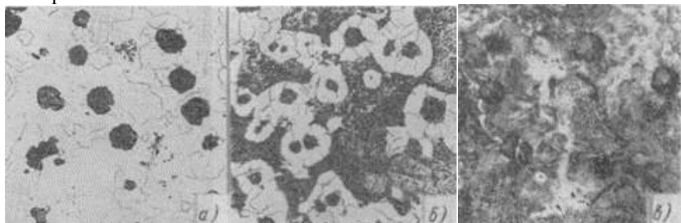
Рис. 10 Высокопрочный чугун (x100)
