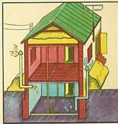
Оборудование подвала дома под противорадиационное укрытие
