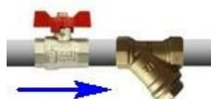
Довольно часто горе-«мастера» монтируют фильтр пробкой вверх –
