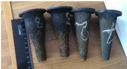
2. Если скачет давление в системе отопления, то возможными причинами может быть коррозия или засорение сопла. Если произойдет разрушение сопла, то давление в расширительном баке отопления может превысить допустимое.
