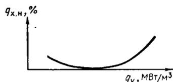
Рис. 2.6. Зависимость потери теплоты от химической неполноты сгорания от объемной плотности тепловыделения
