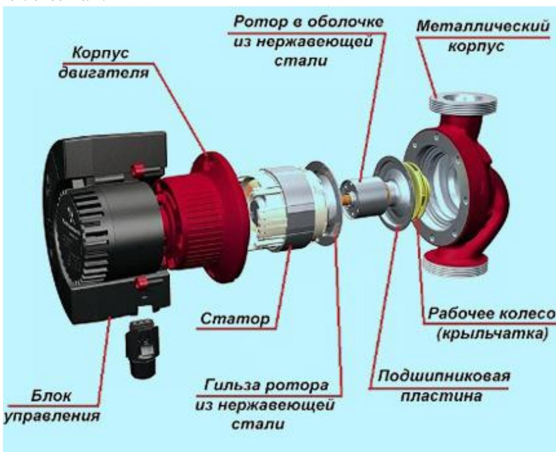
Рис. 1 Циркуляционная помпа (насос)
