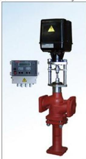
Проблему качественного регулирования помогают решить элеваторы с электроприводом. В них посредством механического привода, вращаемого электродвигателем, увеличивается или уменьшается диаметр сопла. Это реализовано за счет дроссельной иглы конусной формы, входящей в сопло изнутри на определенное расстояние. Ниже изображена **схема элеватора отопления** с возможностью управления температурой смеси:
