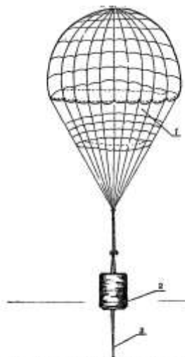
Рис. 56. Ракетная часть 9Д160 после раскрытия парашюта: 1 - датчик; 2 - взрыватель; 3 - взрыватель чувствительный к перегрузкам.
