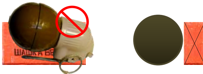
Вид типовой схемы укладки заряда ВВ (200 г) для ручных оборонительных и наступательных гранат
