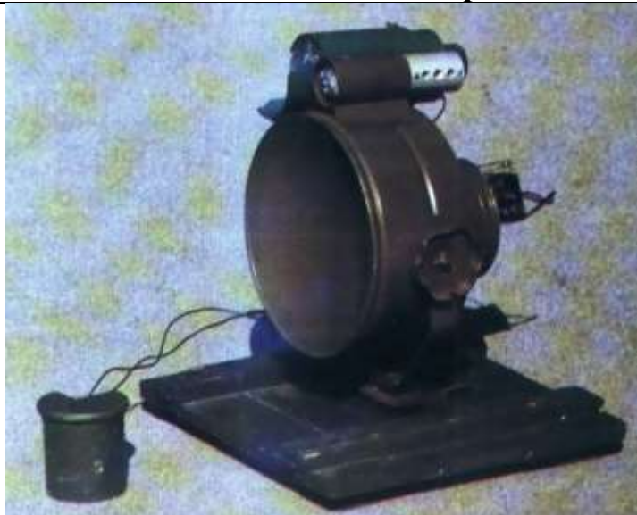
Рис. 19. Взрыватель ТМН-72 (внешний вид): 1 – шпилька; 2 – откидная ручка часового механизма; 3 – предохранительная чека; 4 – пробка гнезда источника тока.
