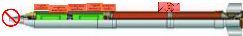
Вид типовой схемы укладки зарядов ВВ при уничтожении РС снабженных боевыми элементами
